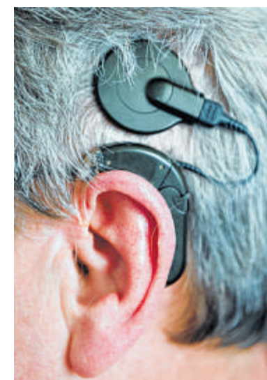
Verbunden wird der Prozessor per Magnethaltung mit dem Cochlea-Implantat.
